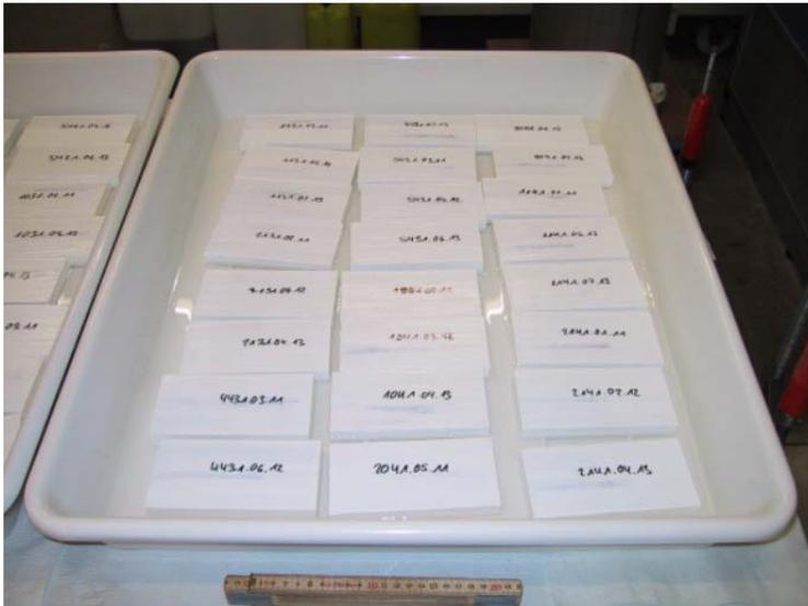
Abbildung 55 Wasserlagerung der Proben zur Bestimmung der Wasseraufnahme
