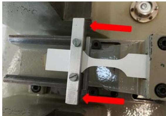
Abbildung 36 Pendelschlagwerk 5102 B von Zwick
