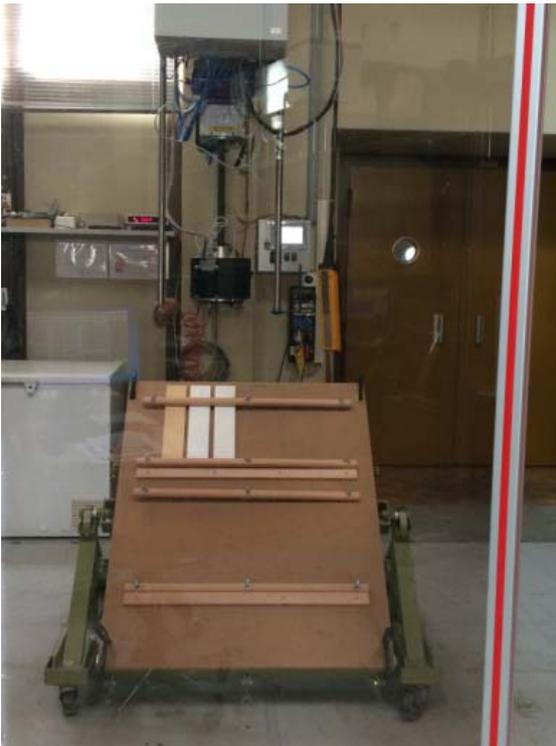
Abbildung 59 Versuchsanordnung Hagelkanone
