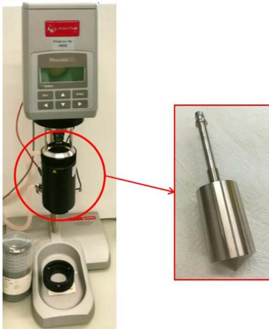
Abbildung 9 Rotations-Rheometer mit konzentrischem Zylindereinsatz
