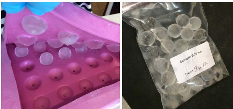
Abbildung 58 Herstellung der Eiskugeln
