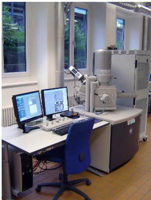
Abbildung 11 Rasterelektronenmikroskop an der Empa
