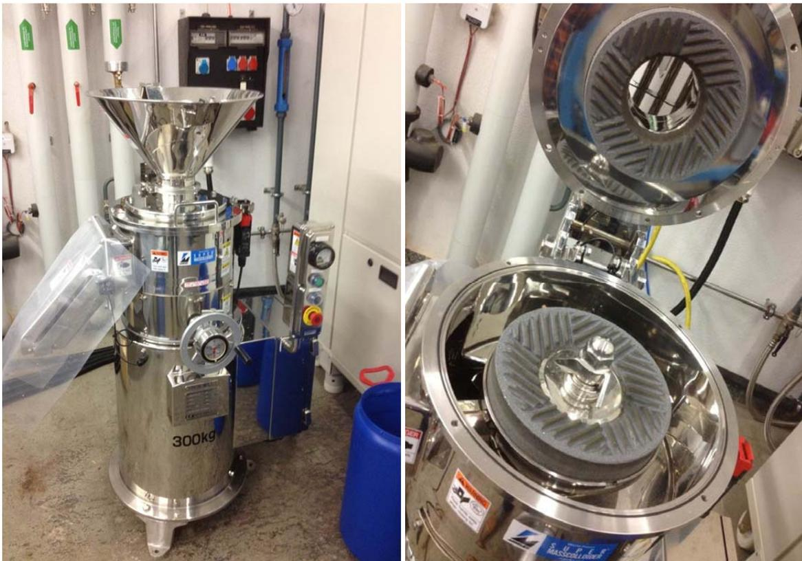
Abbildung 7 Mahlwerk zur Vorzerkleinerung des Kraftzellstoffs
