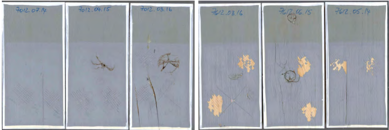
Bild 77: Beispiele von Gitterschnittprüfungen an einer identischen Beschichtung auf unbehandelter (links) und hydrophobierter Holzoberfläche (rechts) nach 2000 h künstlicher Bewitterung im QUV
