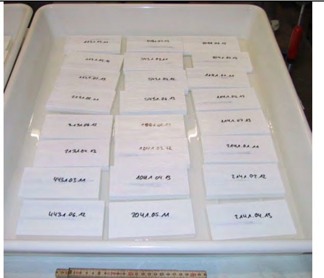
Bild 10: Feuchteschutzprüfung: Bestimmung der Wasserdurchlässigkeit nach EN 927-5
