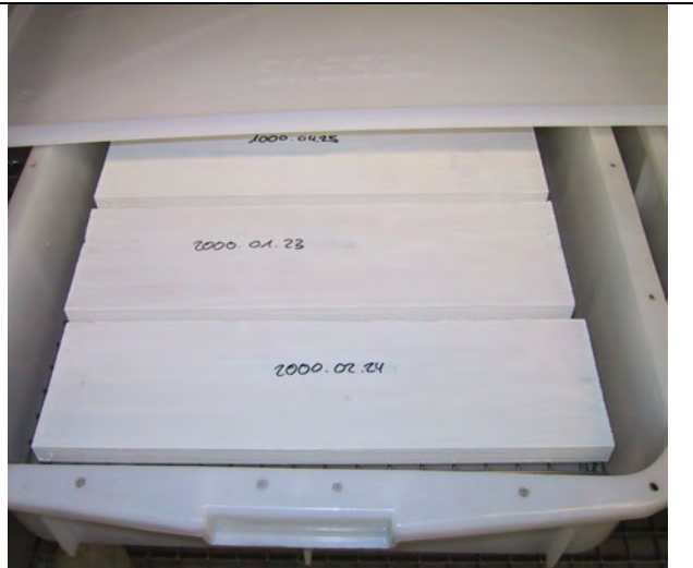
Bild 11: Feuchteschutzprüfung: Bestimmung der Wasserdampfdurchlässigkeit nach EN 927-4
