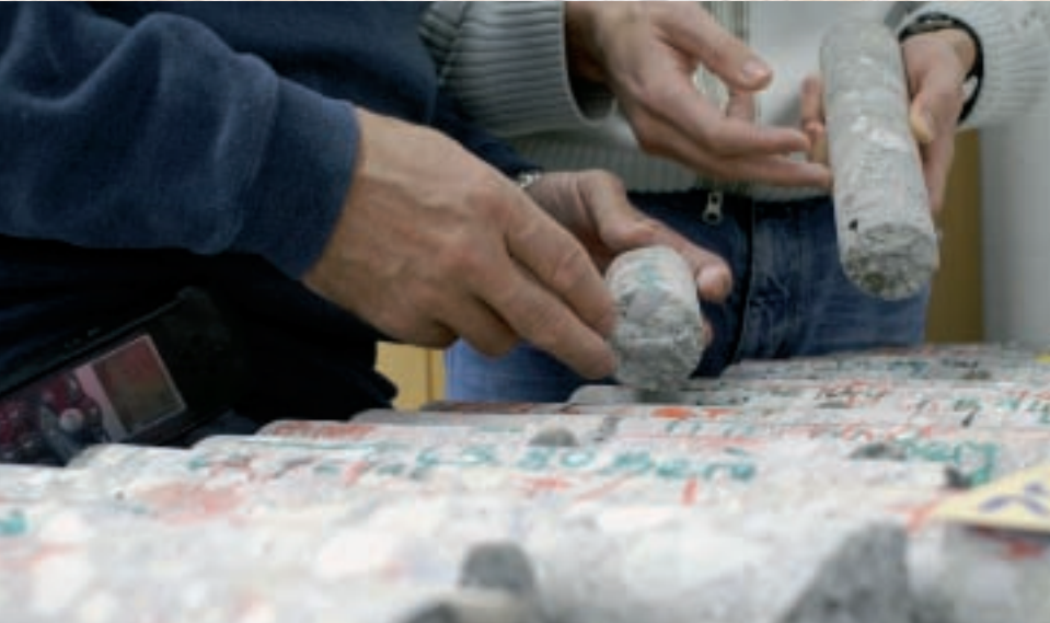
Begutachtung von Bohrkernen
