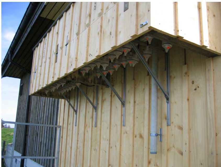
Abb. A5-2: Anordnung der Probenahme mit imprägnierten Filtern an der NABEL-Station Rigi
