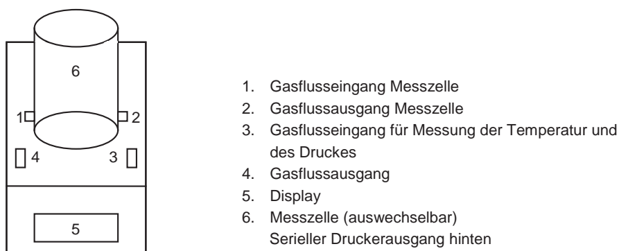
Abb. 4-6: Schematischer Aufbau des DryCal
