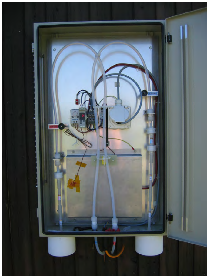
Abb. 3-33: Probenahme Minidenuder-System (MD-System)
