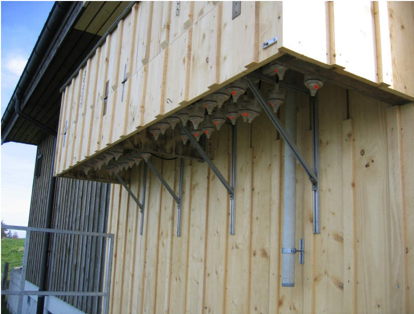
Abb. A2-2: Anordnung der Probenahme mit imprägnierten Filtern an der NABEL-Station Rigi
