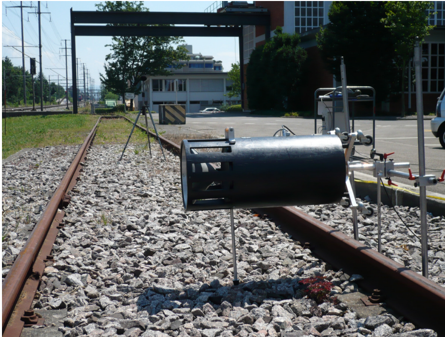
Figure 4.4: Schallausbreitungsexperiment auf einem Industriegleis mit dem anregenden Lautsprecher im Vordergrund und dem Mikrophon im Hintergrund.
