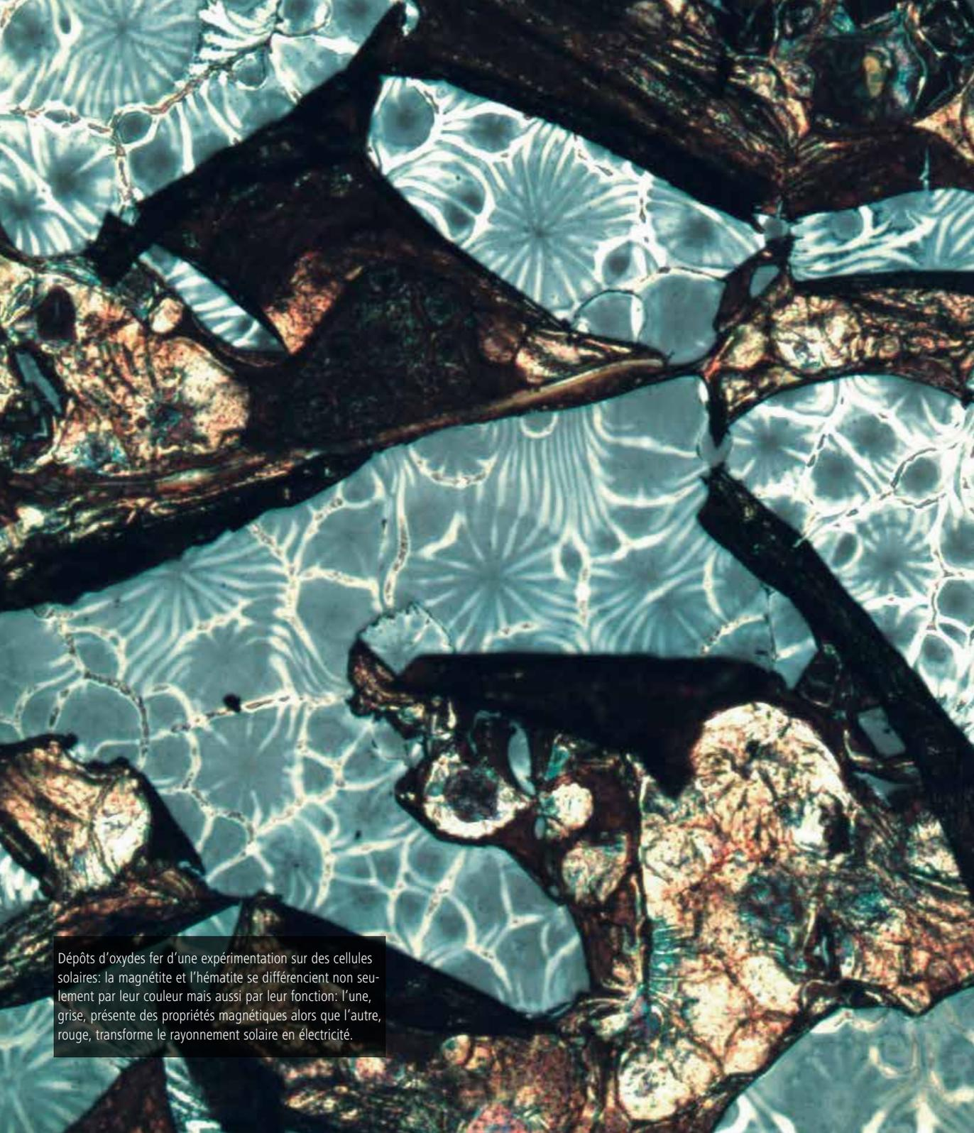
Dépôts d'oxydes fer d'une expérimentation sur des cellules solaires: la magnétite et l'hématite se différencient non seulement par leur couleur mais aussi par leur fonction: l'une, grise, présente des propriétés magnétiques alors que l'autre, rouge, transforme le rayonnement solaire en électricité.
