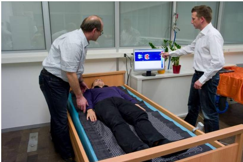
Une natte sensible à la pression est utilisée pour déterminer les points de compression et optimiser les mouvements du matelas.
