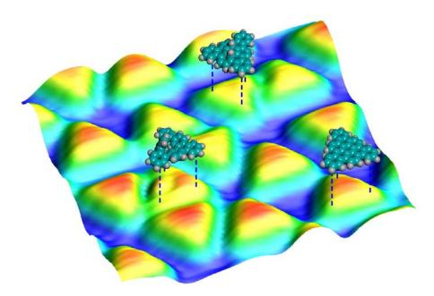
Durch die genaue Kenntnis von chemischen Reaktionen lassen sich diese steuern beziehungsweise die Endprodukte «massschneidern». Rastertunnelmikroskop-Aufnahme mehrerer Nanographene sowie der zwei stabilen Zwischenprodukte auf einer Kupferoberfläche. Die Molekülmodelle zeigen das Nanographen (unten rechts) sowie die beiden Zwischenprodukte (oben und links). Der Durchmesser der Moleküle liegt in der Realität bei etwa einem Nanometer.
