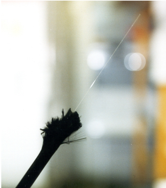
CFK-Draht mit faseroptischem Sensor im Zentrum.
