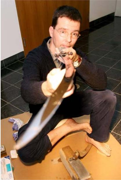
Alemannische Klinge aus dem 6. Jhdt. aus Süddeutschland nach der Behandlung mit der Kantei-Methode. Hell der gehärtete Stahl in der Klinge, dunkel der weichere, kohlenstoffärmere Stahl (Bild S. Mäder).
