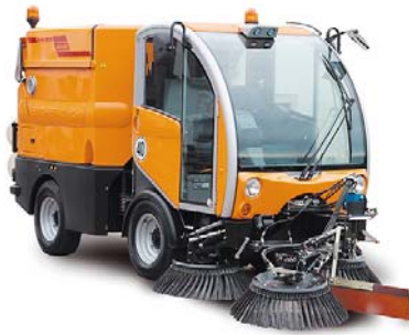
Le véhicule à pile à combustible «hy.muve» (véhicule communal Bucher City Cat 2020)
