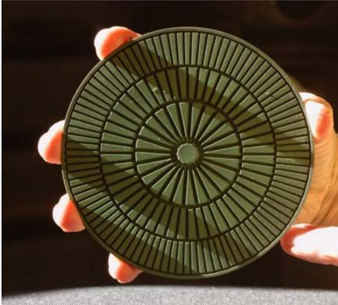
Anode structurée pour piles à combustible développée par l'Empa.
