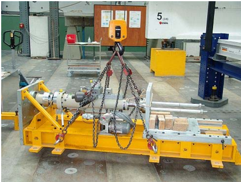
Un des deux excitateurs de vibrations (shaker) dans la halle de génie civil de l'Empa.
