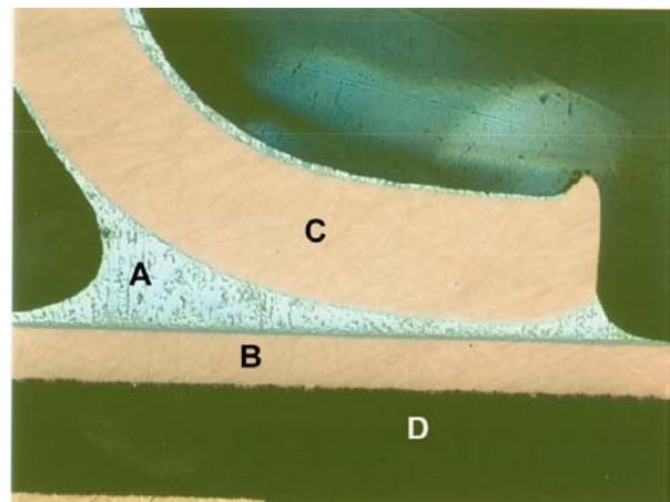
Querschnitt einer Lötstelle unter dem Mikroskop: Das Zinn-Silber-Kupfer-Lot (A) verbindet die Kupfer-Lötlfläche (B), die mit einer Nickel-Gold-Schicht vor Oxidation geschützt ist, mit dem Bauteilanschluss (C) aus Kupfer. (D) stellt die Leiterplatte aus Harz dar.
