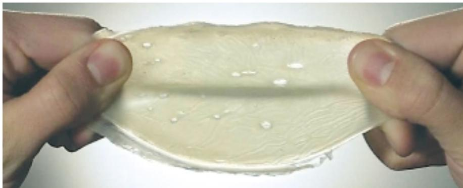
*La réticulation des PHA insaturés permet de produire un caoutchouc biodégradable.*
