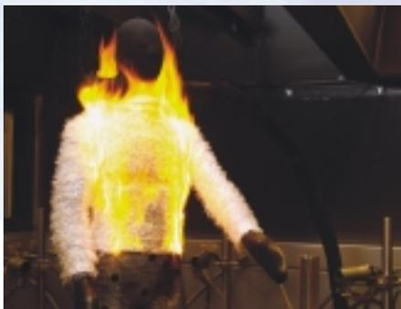
*Mesure des effets de l'inflammation des vêtements par simulation sur le mannequin «Henry». Sur la photo, Henry subit un redoutable «surface flash».*
