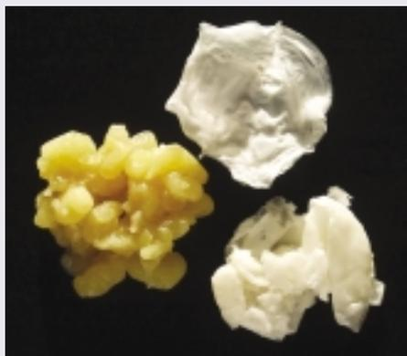
*Polyhydroxyalcanoate (PHA) avant (à gauche) et après purification (au centre et à droite).*
