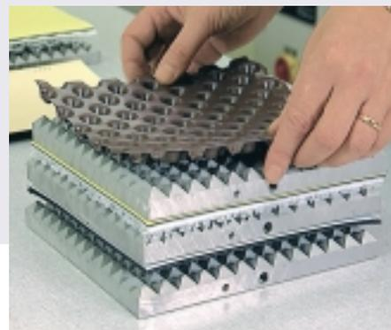
*Système d'étanchéité entre plaques de compression striée et lisse.*
