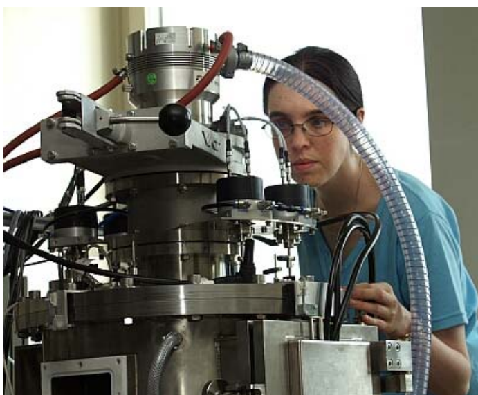
Particolare di una camera di deposizione sotto vuoto per la realizzazione di rivestimenti sottili e nanostrutturati (in alto si ha il sistema di pompaggio). (Dr.ssa Sara Romer)
