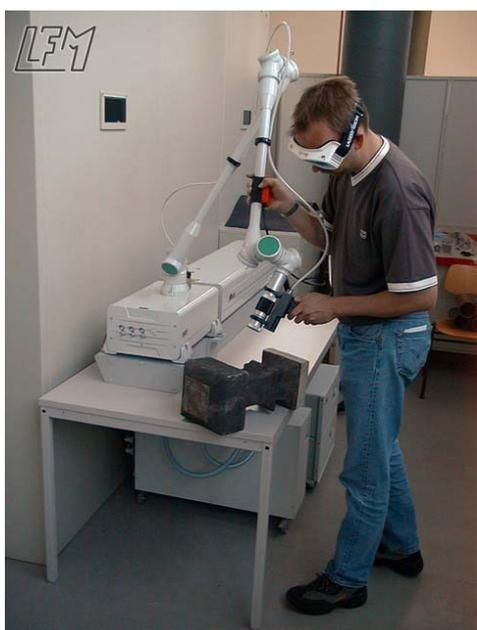
Nettoyage au laser dans le laboratoire de la Haute école spécialisée de Münster.
