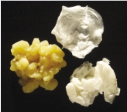
Rohextrakte von Polyhydroxyalkanoat (PHA), vor (links) und nach der Reinigung (Mitte, rechts).
