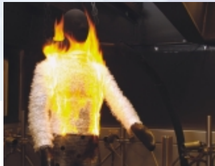
Praxisnahe Messung der Auswirkungen von Kleiderbränden an der Puppe «Henry». Im Bild erleidet Henry einen gefürchteten «Surface Flash».
