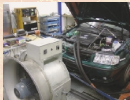
Das Clean Engine Vehicle auf dem Rollenprüfstand.
