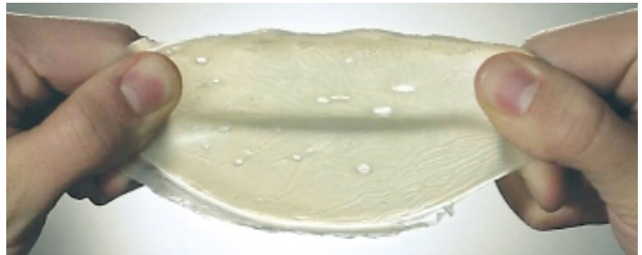
Quervernetzung in ungesättigten PHA ermöglicht die Herstellung eines bioabbaubaren Gummis.
