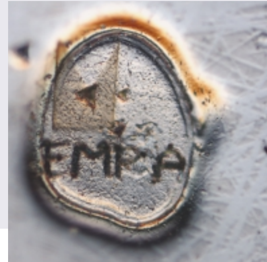
«Empa» – mit Nanowerkzeugen auf einen Haarquerschnitt eingraviert.
