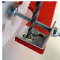
zweite Bohrung durch Alu
